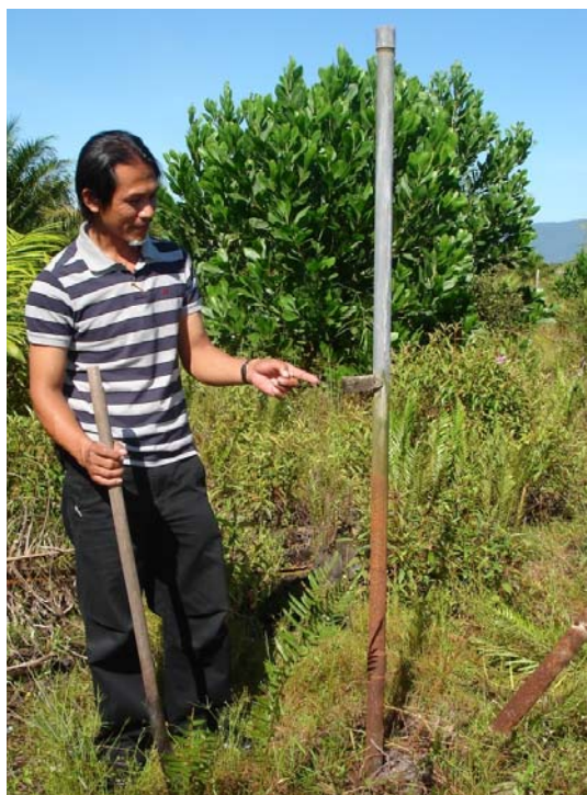
ภาคผนวกที่ 13 การยุบตัวของดินพรุในพื้นที่พรุบาเจาะ
